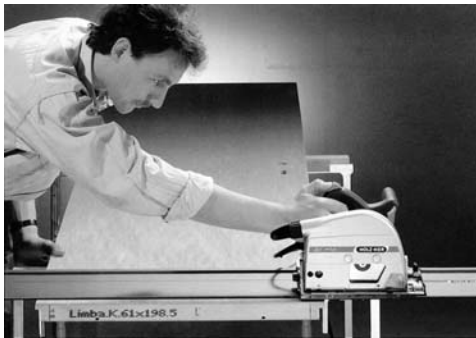
Bild 5.48 a) Vorritzen, b) Trennen
