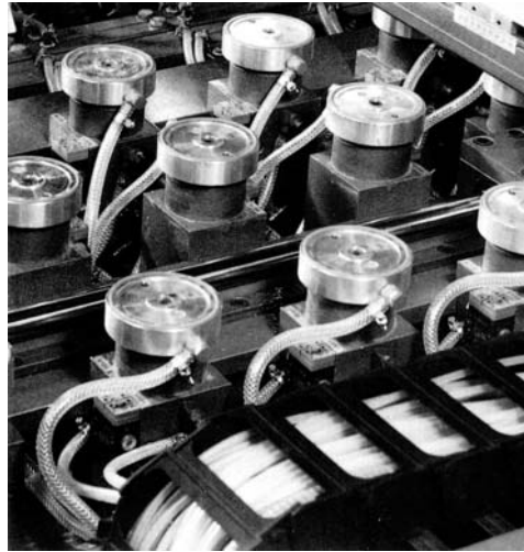
Bild 5.148 Werkzeugaufspannung durch Vakuumsaugteller
