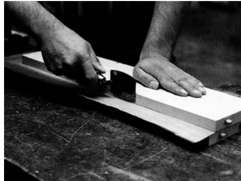
Bild 3.124 Zuschneiden mit der Furniersäge
