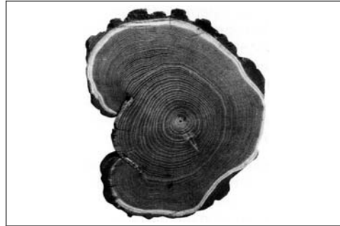
Bild 3.39 Überwallung nicht gelungen (Douglasie)
