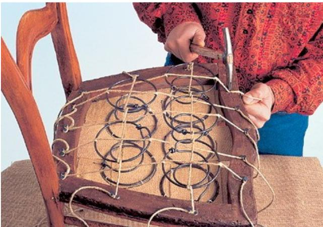
Поперечную натяжку начните с передней части. Пружины стяните таким образом, чтобы они имели наклон в сторону задней части сиденья (в перпендикулярном направлении стягивание проводите при одинаковом натяжении бечевки).
