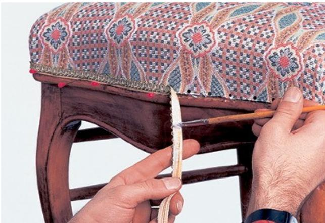
После фиксации ткани на передние гвозди и в соответствующие пазы нанесите тонкий слой клея, следя за тем, чтобы он не испачкал декоративную обивку.
