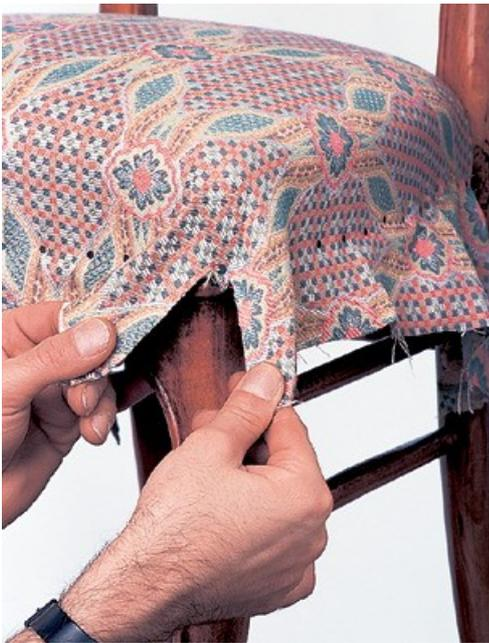
Сложите мебельную ткань в складку, затем закрепите гвоздями. Такая отделка наиболее характерна для стульев с закругленными углами. Если вы хотите, чтобы получилась более заостренная форма, то сделайте простую складку.
