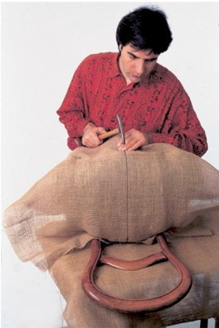
Накройте слой наполнителя джутовой обивочной тканью и прочертите на ней осевую линию.
