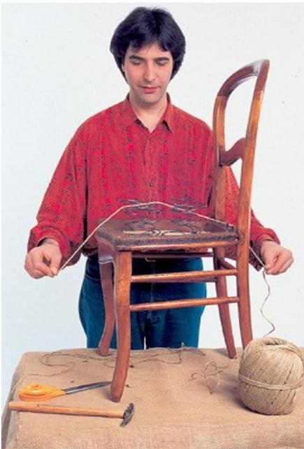
Приготовьте две бечевки для двух рядов пружин (каждая из них должна быть длиннее, чем ширина стула примерно в полтора раза).
