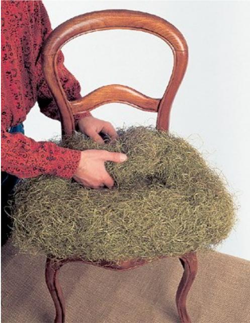
В образовавшуюся "прогалину" в центральной части сиденья уложите подстилку толщиной 2-3 см и разгладьте. В передней части стула должно быть немного больше наполнителя, чем в задней.
