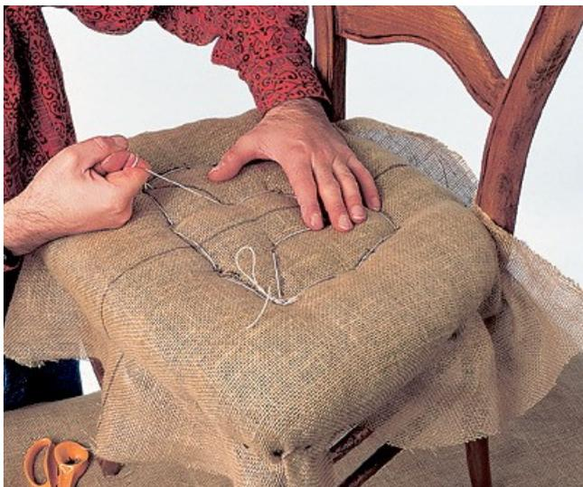
Прошейте иглой сидение по всему периметру. При этом шнур должен все время оставаться внутри стула. Когда ушко иглы начнет ходить свободно, протолкните ее так, чтобы она вышла примерно в 5 мм от предыдущей точки. Таким образом прошейте весь периметр и центральную часть, затем стяните точки.
