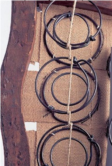
Стяните пружины каждого ряда бечевкой, обмотав ею две противоположные точки окружности. Края бечевки закрепите гвоздями.
