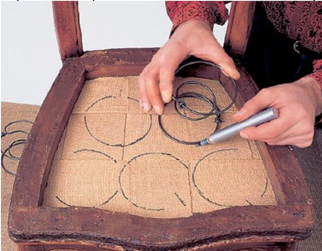
В определенном порядке установите пружины, при этом узлы на их верхних окружностях должны сходиться к центру сиденья. Затем обведите пружины фломастером.
