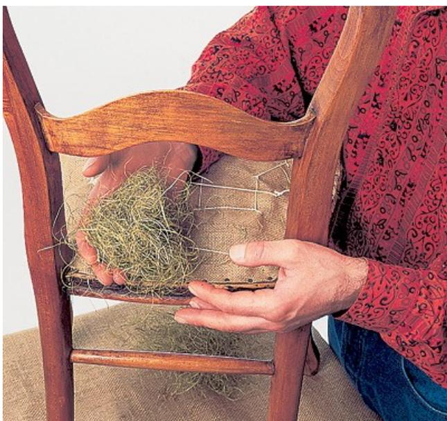
Наложите пучки волосяного наполнителя по всему периметру сиденья. Расчешите, скрутите и заправьте его под бечевку. Каждый пучок соедините с предыдущим, расправив волокна так, чтобы получился слой с равномерной плотностью.
