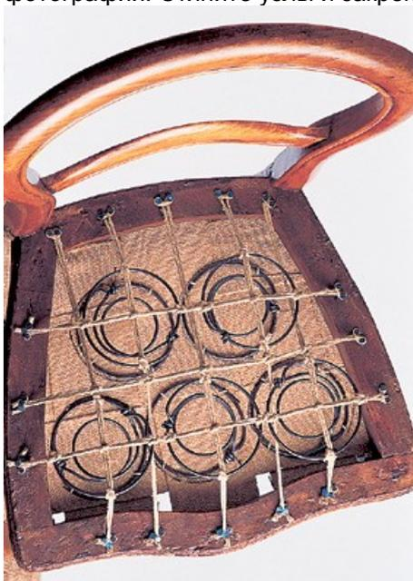
Окончательно зафиксируйте положение пружин в горизонтальной плоскости, связав пересекающиеся ряды бечевки. Рекомендуем укрепить конструкцию дополнительными промежуточными шнурами, протянутыми и завязанными между рядами пружин.
