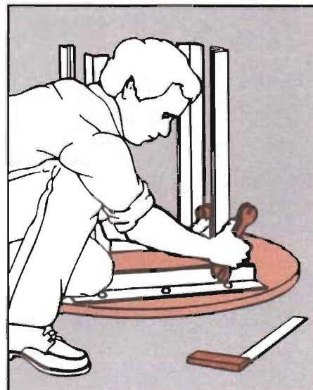
**2 Присоединение крышки к основанию.** Используйте быстрос действующие зажимы для крепления 600-миллиметровых отрезков бруска 100×50 мм примерно на  $\frac{1}{6}$  высоты каждой пары ножек. Затем наполните бочку бетоном и «утопите» в нем ножки так, чтобы заготовки 100×50 мм расположились по краям бочки. Ослабьте зажимы и установите правильное положение ножек (поверхность верстака должна быть на уровне кулаков — обычно 750 мм). Снова затяните зажимы.
