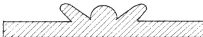
**Рис. 19.** Поперечный разрез орнамента плоскорельефной резьбы с поднутренным фоном
