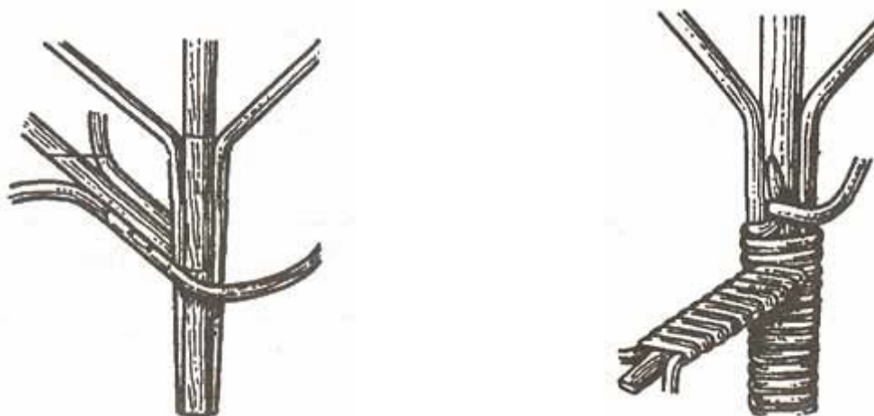
Рис. 20. Соединение деталей внакладку
