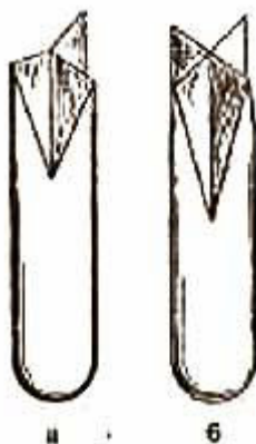
Рис. 2. Колунки для расщепления прута: а - на три части; б - на четыре части
