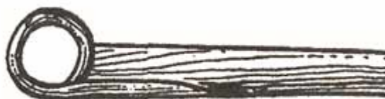
Рис. 21. Соединение деталей на косой срез
