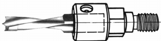
Рис. 100. Крепление сверла в патроне со стопорным винтом
