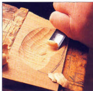
Emplee una gubia de canal exterior para vaciados.
