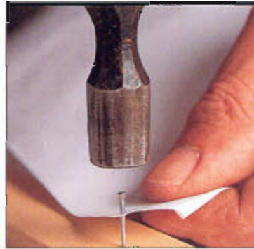
Clave puntas pequeñas con un martillo de puntas, inmovilizándolas con un papel.
