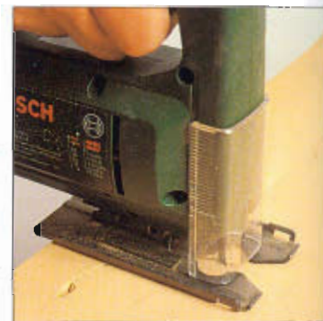
Con una sierra de vaivén practique un corte interior limpio.
