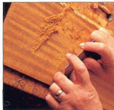
Sujete el rascador con las dos manos.
