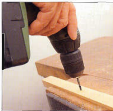
Coloque la broca y empiece a presionar el gatillo.
