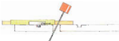
Corte ángulos en ingletes con la guía.
