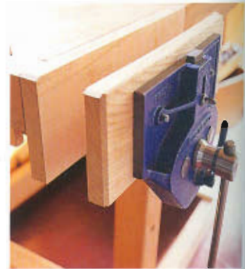
Un tornillo grande es muy útil para sujetar bien las piezas.
