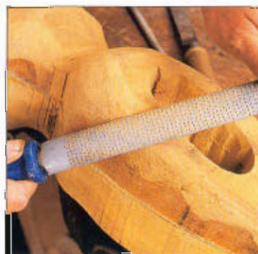
Desbaste la madera con una escofina.
