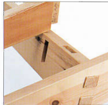
Encaje las sujeciones del asiento en el travesaño longitudinal trasero.
