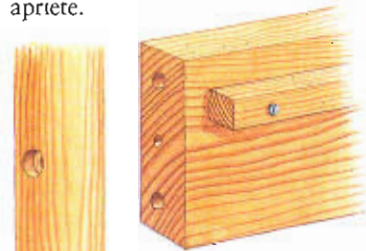
Fije el calzo en su lugar, sobre la cara interior del travesaño de la cama.
