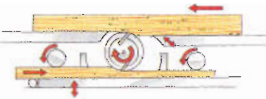
Sección de la cepilladora universal que muestra la cepilladora y la regruesadora.
