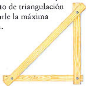
El triángulo es la estructura más firme.
