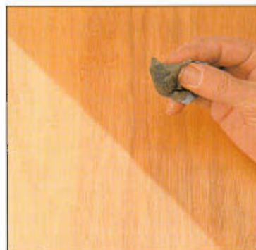
Aplicación de aceite con un trapo.
