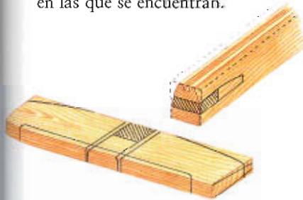
Marque las posiciones de los ensambles a media madera.
