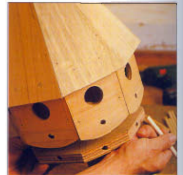
Inserte las clavijas para sujetar la base.
