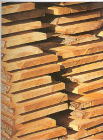
Madera secándose de forma natural al aire libre, con los listones espaciadores entre las tablas.
