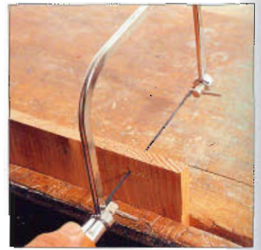
Lleve la segueta hacia usted al cortar.
