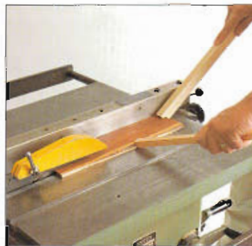
Por seguridad, al usar la sierra empuje la madera con un bastón.
