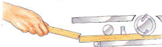
Use unos bastones para empujar la madera hacia los rodillos de alimentación.
