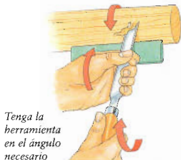
Coloque la hoja en el portaherramientas.
