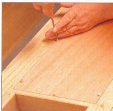
Atornille los paneles traseros en posición.
