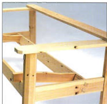
Las sujeciones del asiento perfiladas, en posición sobre el marco final.
