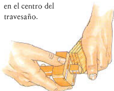
Trace el grosor de la espiga con un gramil de caja.
