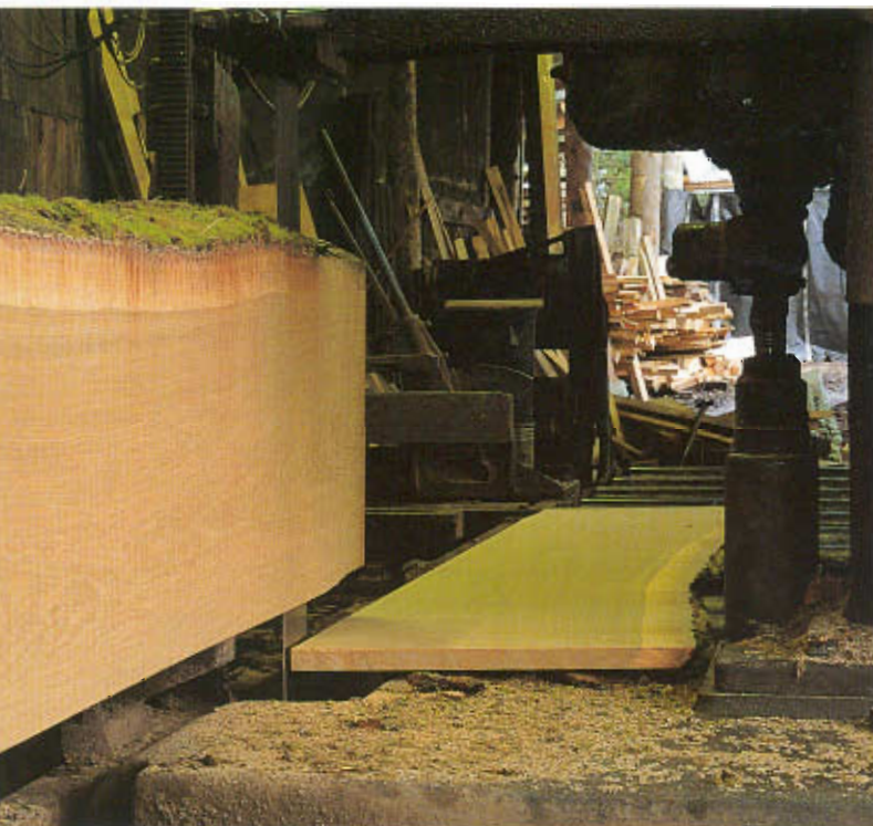
Aserrado de madera en cachones en el aserradero.
