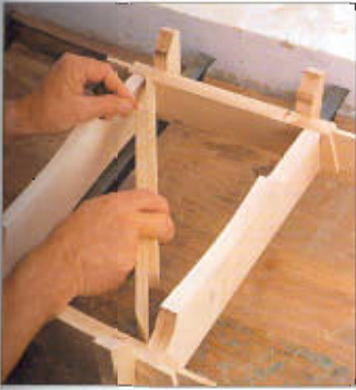
Use listones superpuestos y biselados para medir una diagonal.
