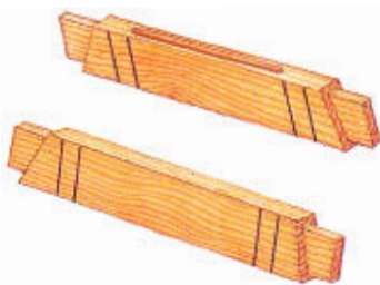
Marque y corte los travesaños delantero y trasero.
