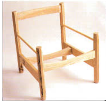
Montaje en seco del bastidor.
