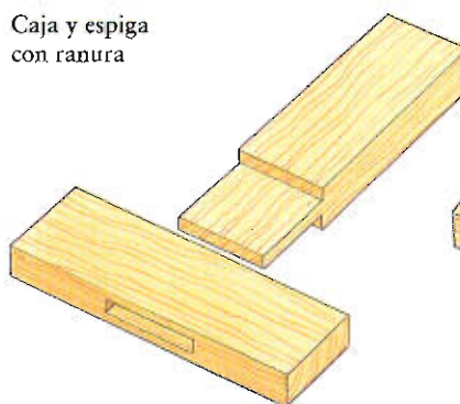
Caja y espiga con ranura, reforzado con cuñas
