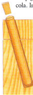
Apriete la tira trasera contra las espigas, a punto para introducir las cuñas.
