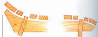
Coloque las tablillas para componer el asiento.
