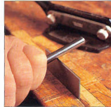
Elabore una rebaba en la hoja del rascador.
