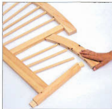
Extienda las clavijas abiertas y fije a los travesaños curvos.
