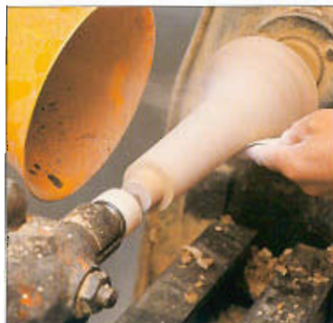
Use un aspirador para lijar con el torno en funcionamiento.
