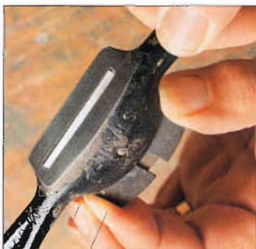
Ajuste la proyección de la hoja de raspadera.
