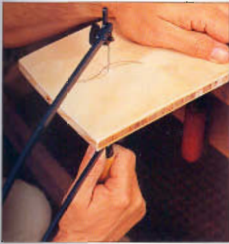
Tire de la sierra de calados para cortar.
