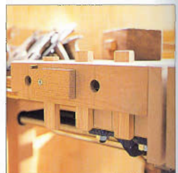
Topes hechos con una leva de madera.
