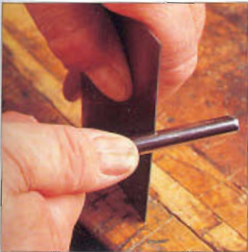
Con un bruñidor, cree una rebaba en el filo del rascador.
