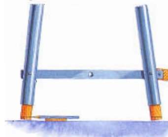
Bisele muy levemente las patas para que el taburete esté perfectamente plano.
