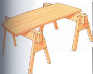
Para cortar al hilo, coloque la madera horizontalmente sobre unos caballetes.
