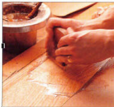
Extienda la primera sección de chapa con un martillo para chapa.
