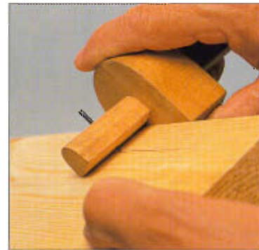
Trace una línea con un gramil de reglaje.
