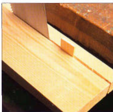
Corte al hilo introduciendo cuñas en la vía para separar la madera.
