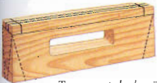
Trace y corte las lengüetas e inclinaciones de las asas.
