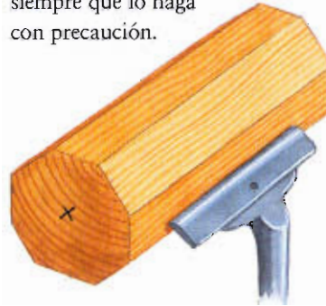
Es más fácil convertir la pieza del huso en un octágono antes de tornear.
