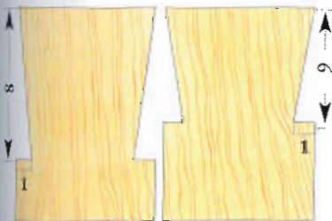
Ángulo para maderas de fronda.
