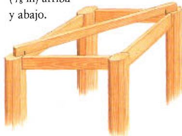
Compruebe que el marco preensamblado está perfectamente recto.
