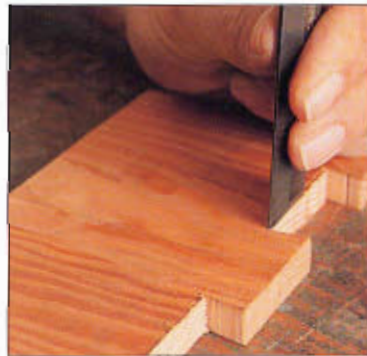
Con un escoplo, vacíe los intervalos de las colas de milano.
