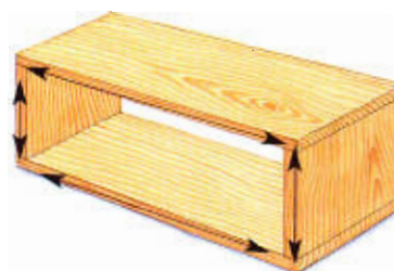
Construcción que ilustra el movimiento de las fibras.
