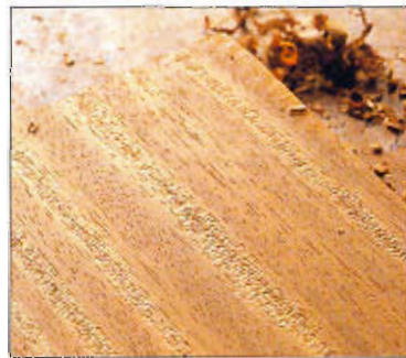
Fibra alternada después del cepillado.
