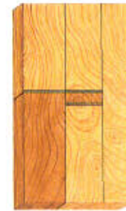
Marque las patas. La zona sombreada muestra la madera de desecho, y las dobles líneas el ensamble de cola de milano.
