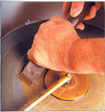
Afile el formón en la piedra a un ángulo aproximado de 25°.
