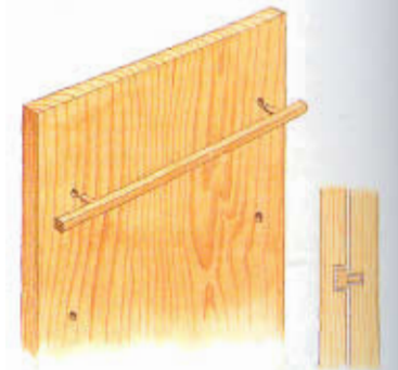
Los cajones se fijan con vías.
