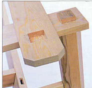
Corte dos cajas a los extremos del travesaño trasero, para encajar los brazos.
