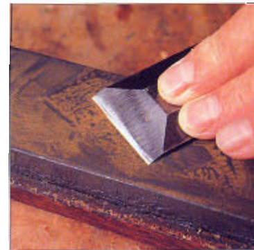
Elimine la rebaba para conseguir un borde afilado.
