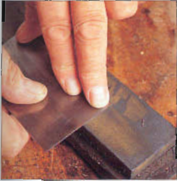
Alinee los lados del rascador sobre una piedra al aceite.
