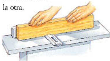
Traspase la madera de mano a mano al pasarla por las cuchillas.
