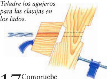
Taladre los agujeros para las clavijas en los extremos de los estantes.
