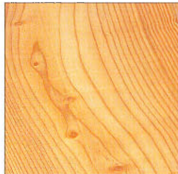
Madera de fibras imbricadas.
