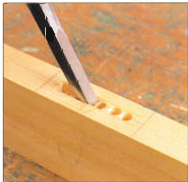
Desbaste la caja a formón después de practicarle una serie de agujeros.
