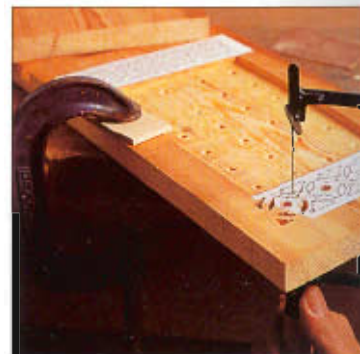
Corte el dibujo con la sierra de calados.
