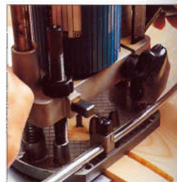
Corte una ranura con la fresadora y la ayuda de un soporte guía.
