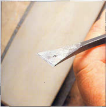
Produzca una leve rebaba en el borde cortante.
