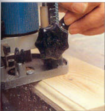
El borde a moldurar debe sobresalir del banco suficientemente.
