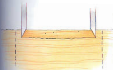
Elimine una primera capa de material sobrante del hueco o caja.
