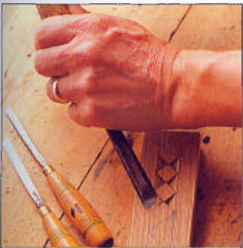
Practique la talla con el formón y el mazo sobre madera de desecho.
