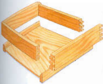
Construcción de cajón estándar.
