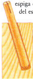
Encere la espiga e insértela en el estante.
