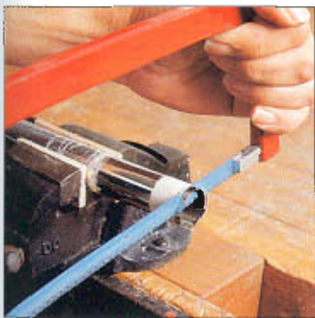
Corte en tubo metálico con una sierra de arco para metales.
