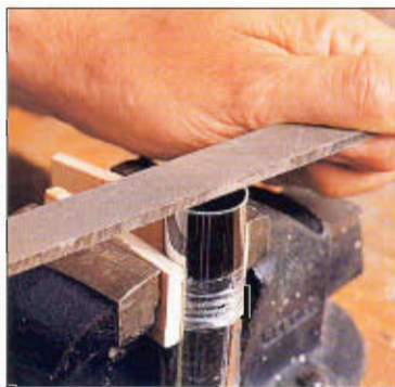
Lime el tubo de lado a lado.
