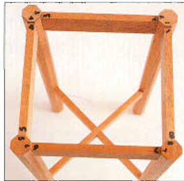
Ensamble el bastidor en seco.
