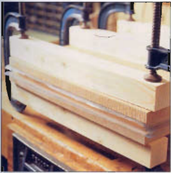
Las capas de chapa en la horma.
