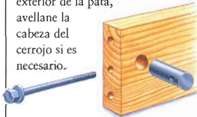
Taladre agujeros para el cerrojo y la tuerca en los travesaños de la cama.
