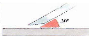
El ángulo de afilado debe tener 30°.
