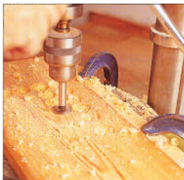
Use una broca Forstner para desbastar el hueco del espejo.
