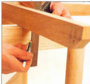
Marque el grosor del travesaño superior en los travesaños cruzados ya ensamblados.
