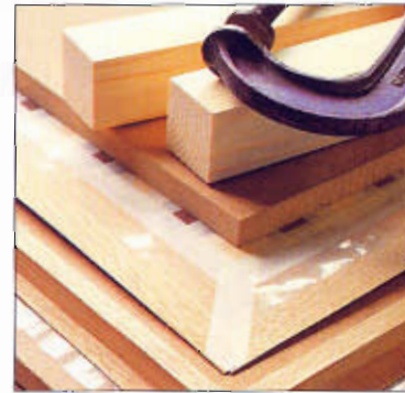
El conjunto para chapas de damero consiste en hoja de polietileno, horma, chapa de refuerzo, alma del tablero y chapa del anverso.
