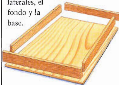
Prepare los materiales de los laterales, el fondo y la base del cajón.
