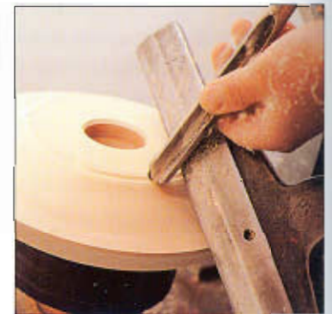
Tornee la curva de la pieza superior del macetero.
