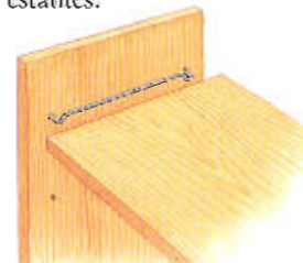
Coloque los tubitos de acero en el interior del cubo para aguantar el estante.
