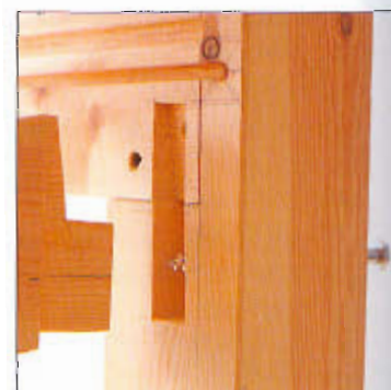
Fije el travesaño intermedio, tras fijar el travesaño horizontal de soporte.
