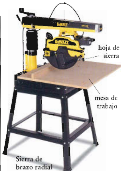
Sierre la madera en piezas paralelas.
