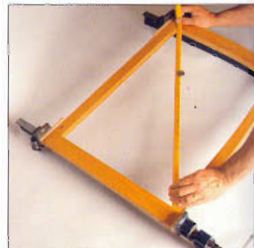
Mida la diagonal para comprobar si el marco está recto.
