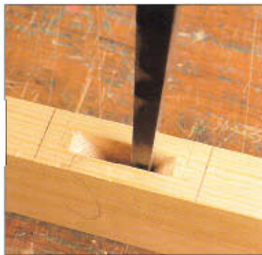
Corte a formón una V central en la caja.
