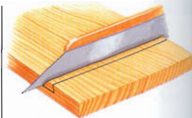
Corte la ranura de cola de milano con un serrucho de costilla.
