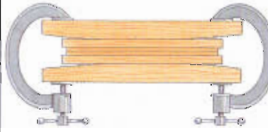
Apriete las mordazas para ejercer la presión final.
