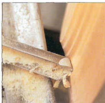
Sitúe la hoja en la dirección del movimiento.
