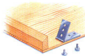
Atornille la bisagra a la parte baja del asiento.
