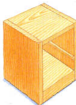
Armario reforzado con una guía ancha y un panel posterior.
