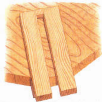
Fabrique una plantilla para la fresadora.
