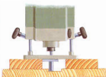
Construya una plantilla para la fresadora para desbastar.
