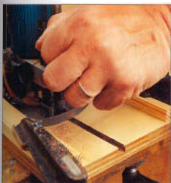
Realice una ranura con la fresadora y listones laterales.
