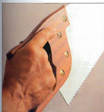
Forma correcta de asir el serrucho.
