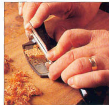
Rasque la superficie cuidadosamente con la guimbarda.
