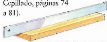
Compruebe si es plana con una regla recta.
