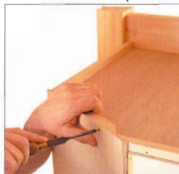
Complete la parte trasera de la sección de almacenamiento superior.
