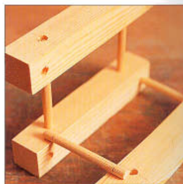
Introduzca adhesivo en los agujeros y presione para encastar las espigas.
