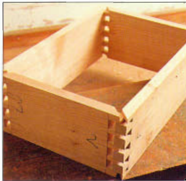
Encaje parcialmente los lados de la caja.
