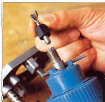
Inserte la fresa en el portafresas.
