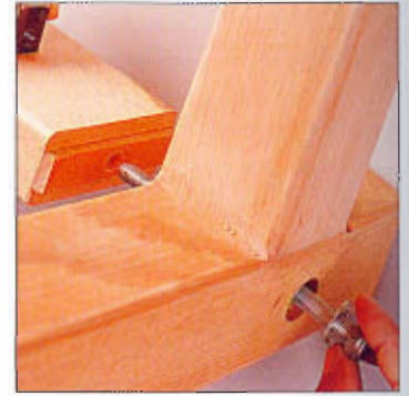
Fije los travesaños inferiores a los marcos laterales con una tuerca y un cerrojo.
