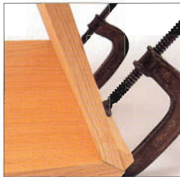
Amordace las esquinas inferiores ingletadas de la carcasa triangular.
