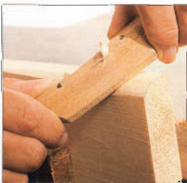
Atornille la pieza y tome la raspadera con las dos manos.
