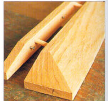
Corte el bisel a lo largo y a los laterales del estante.
