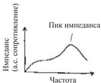
Диаграмма показывает типичную зависимость импеданса датчика (а.с. сопротивления) от частоты
