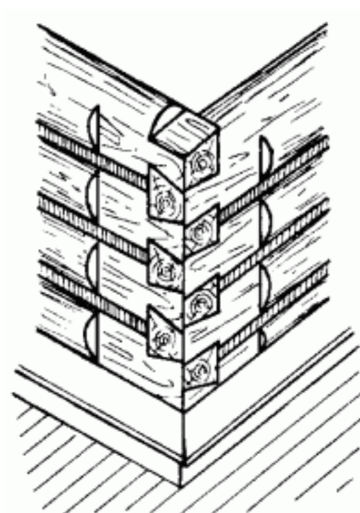
Рис. 61. Схема крепления сруба в лапу.
