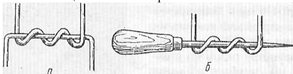
Петля из проволоки: а-со скобой в сборе; б-изготовление
