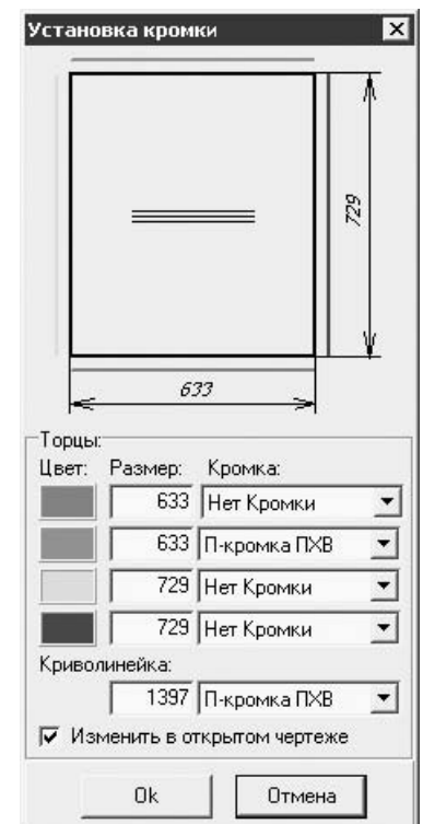
Рис. 5.31 Окно Установка кромки
