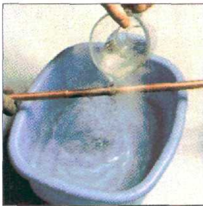
Поливая раскаленный материал водой (если возможно - погружая в воду), вы охладите его и снимете внутренние напряжения.
