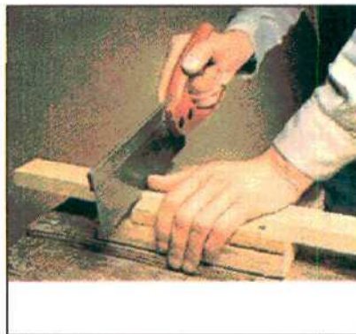
Заготовки крепко прижимаются к притолоке, ее правый край направляет пилу.
