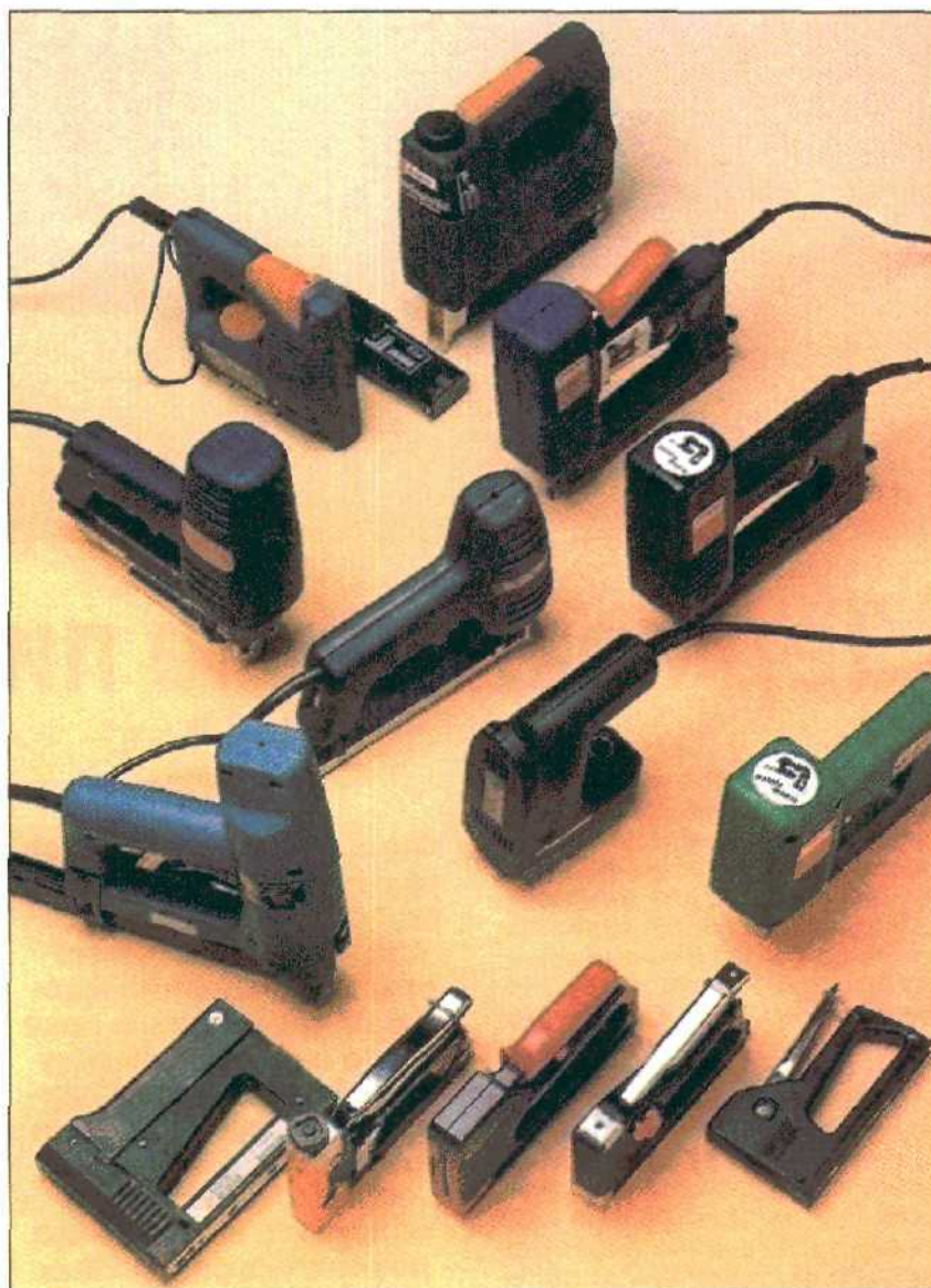
Современные модели ручных (нижний ряд) и электрических тэкеров. На самом верху - аккумуляторный тэкер.
