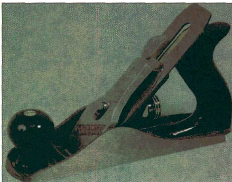
Современный металлический рубанок с обычным расположением винтов, из которых наиболее важным является прижимной винт, регулирующий положение ножа.
