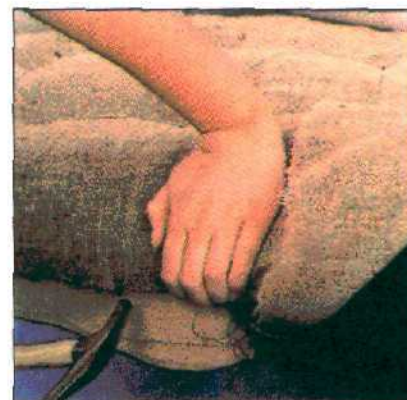
4. После заполнения каркаса обтяните набивку холстом. Края ткани закрепите гвоздями.
