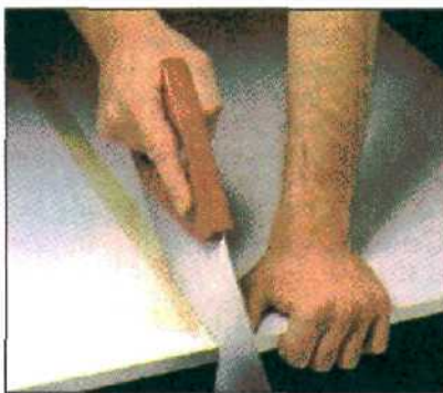
Клеящая лента предотвращает расщепление поверхностного слоя плиты при распиливании. Ручную пилу нужно приставить с максимальным наклоном.
