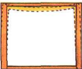
Из-за большой нагрузки прогибаются даже толстые бруски.
