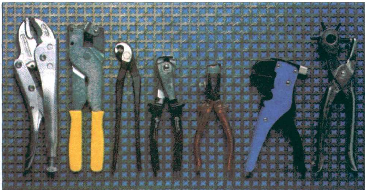
Набор специальных клещей слева направо: зажимные щипцы, клещи для работ с плиткой, дыропробивные клещи для плитки, кусачки, клещи для удаления изоляции и дыропробивные клещи-револьвер.
