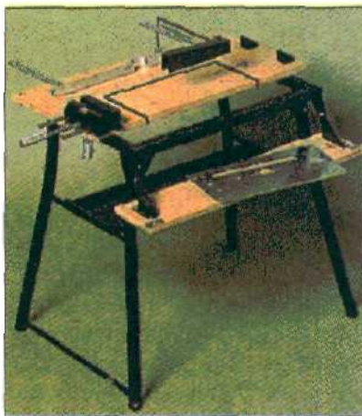
Обрамленную темной рамкой часть раздвигаемой столешницы можно заменить металлической пластиной с выемками для пилы или фрезы.
