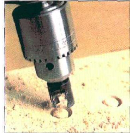
Резцами для заглушек высверливают или фрезерируют заглушки из дерева, с помощью которых закрываются утопленные шурупы.
