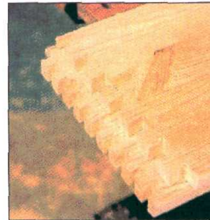
5. Расположение шипов и пазов может быть частым или редким в зависимости от того, какой шаблон и каких размеров фреза используются.
