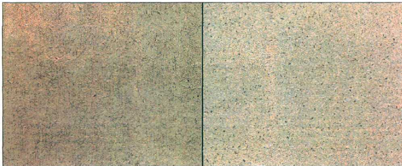
Вид сверху на волокнистую (слева) и древесно-стружечную плиту (справа).
