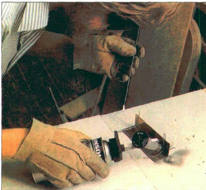
Такое угловое соединение встык лучше предварительно закрепить проволочными фиксаторами: это облегчит пайку непрерывного шва.
