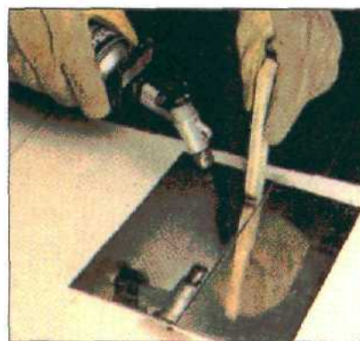
Обработку пламенем ведите от края к середине. По изменению окраски, особенно заметному у медных и латунных листов, можно видеть, как постепенно нагревается лист.
