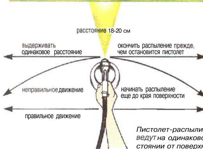
Обширные поверхности окрашивают параллельными полосами; по краям они должны взаимно перекрываться.
