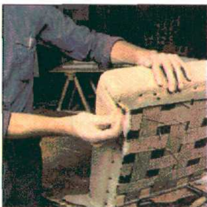
2. Если вы обтягиваете острый угол, а ткань очень толстая, то вам поможет V-образный надрез.
