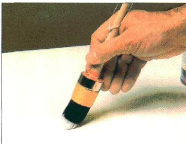
Нужно нанести и отшлифовать минимум три слоя лака, чтобы поверхность стала безупречной. Но и пять, и даже шесть слоев - не исключение.
