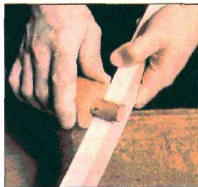
Рейсмусом отмечают половину толщины планки с узких сторон.
