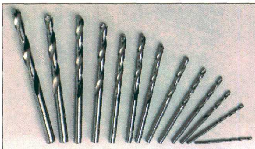
Новые металлические сверла с конической заточкой. Они не выскальзывают и высверливают абсолютно круглые отверстия.
