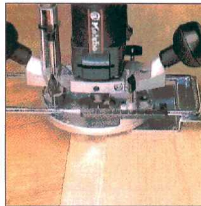
В зависимости от характера изделия и обработки параллельный упор либо цепляют за направляющую планку, либо прижимают к ней сбоку.
