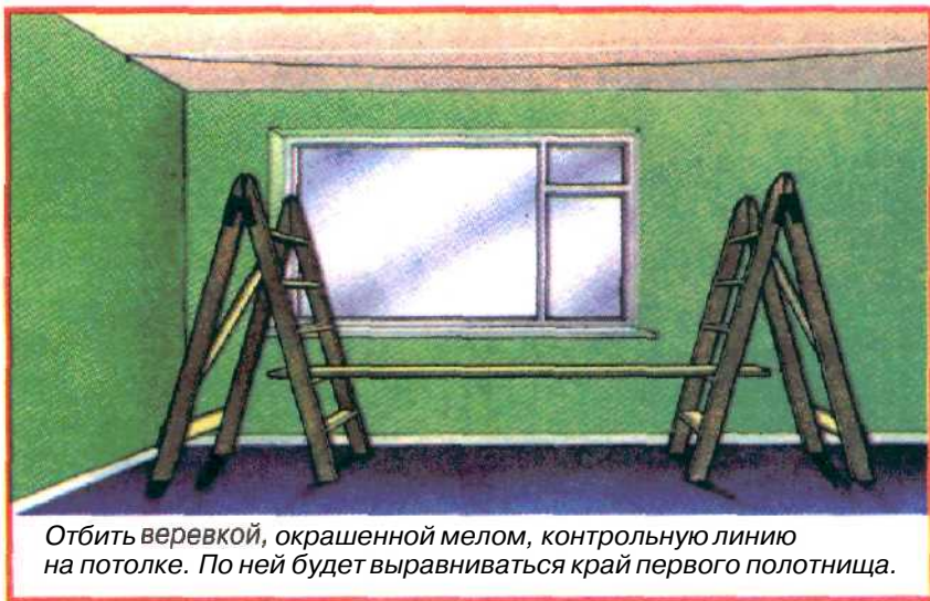
Помост установлен правильно, если, стоя на нем, можно кистью руки легко дотронуться до потолка.
