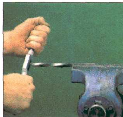
Вороток, который обычно применяют для вращения метчиков, подходит для изготовления декоративных витых стержней из стали.
