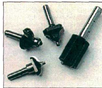
Слева направо: фрезы с различными профилями, с цапфами и без них, а также с широким желобком.
