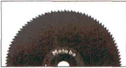
Пилящий диск со 112 острыми мелкими зубьями для распиливания фанеры; оставляет ровный срез.
