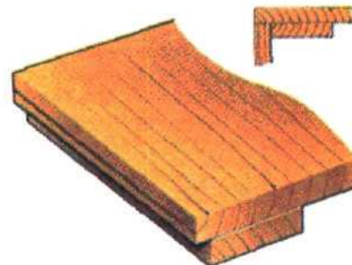
Укрепление с отступом от края.
