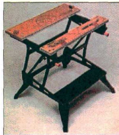
Заднюю часть столешницы можно переставлять, чтобы образовалось свободное пространство нужной ширины для удобного размещения обрабатываемой детали.
