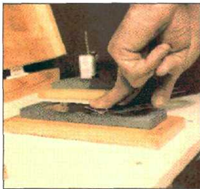
3. Когда на режущей кромке появляется заусенец, нож, перевернув, кладут на брусок плашмя и перемещают туда-сюда, чтобы удалить заусенец.
