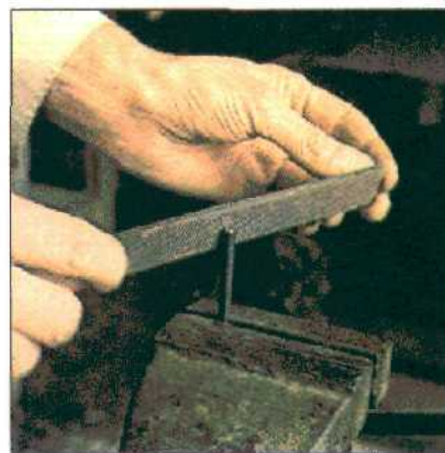
Верхушку зажатого в тисках круглого стержня обрабатывают напильником, чтобы образовалась фаска.
