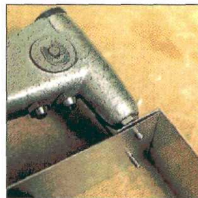
Снимок наглядно показывает, как сферическая головка на конце штифта стягивает заклепку: когда штифт протянут насквозь, он обрывается.
