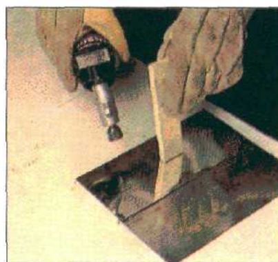
Разогревайте детали равномерно. Горелку держите под небольшим углом к поверхности. В целях безопасности придерживайте детали деревянным брусом.
