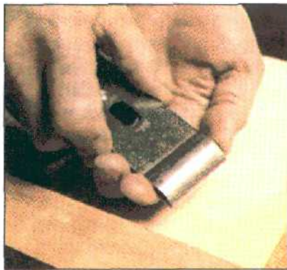
4. Режущая кромка ножа должна выступать за край накладки на 3 мм. Проследите, чтобы выступающая кромка была такой ширины на всем протяжении.
