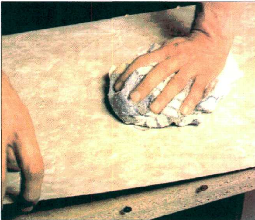
Покрытие из слоистого материала делает древесно-стружечную плиту привлекательной и является одновременно защитой от различных воздействий.
