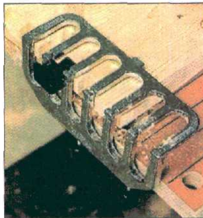
4. Если обрабатываемые детали шире шаблона, то последний можно сместить с помощью пластмассовой цапфы.
