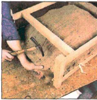
1. На пружины приходится большая нагрузка. Чтобы не повредить набивку, пружины следует обтянуть прочной льняной тканью.
