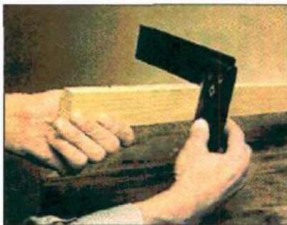
1. С помощью угольника определить, в каком месте заготовки смыкающиеся стороны образуют безупречно прямой угол.
