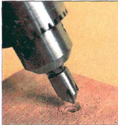
Зенкером только расширяют края просверливаемого отверстия, чтобы плоская головка шурупа легла вплотную с поверхностью изделия.
