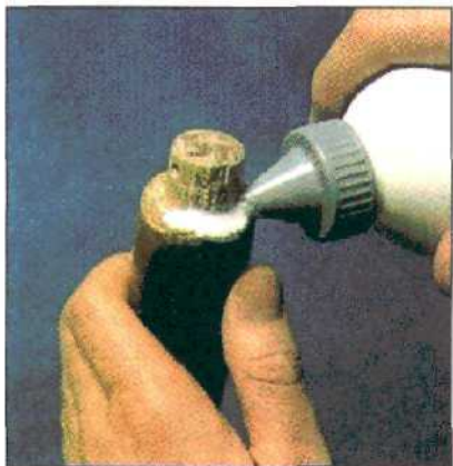
2. Старый клей удалите и по всей поверхности нанесите свежий.
