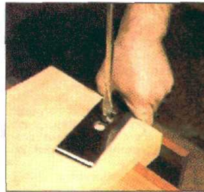
5. Винт, скрепляющий нож и наладку, должен быть туго затянут, чтобы и после долгого использования обе детали плотно прилегали друг к другу.
