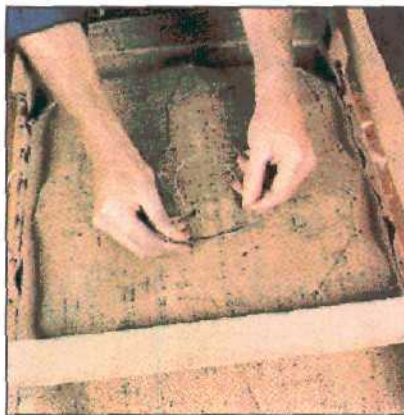
3. При стежке через край нитка образует петлю. Иголочка проводится через петлю, после чего нитка туго затягивается.
