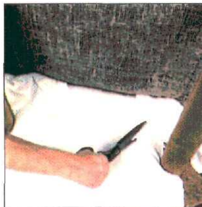
3. Раскрой для задней опоры: ткань с угла надрезать до угла опоры, после чего завернуть внутрь.
