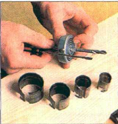
Фланцевое сверло-ножовка способно захватывать до восьми вставок, с помощью которых высверливаются отверстия диаметром до 80 мм.
