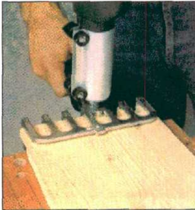
1. При работе фрезой в вертикальной плоскости получают пазы глубиной 13 мм. В толстых деталях пазы выходят полупотайными.
