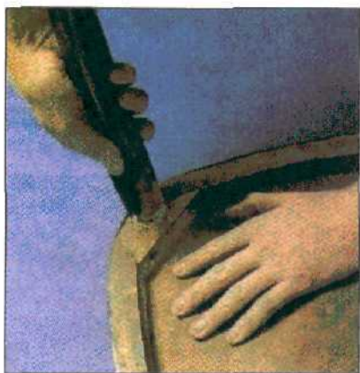
1. Ножку осторожно вытащите из гнезда, стараясь не расщепить дерево.
