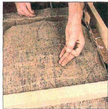
4. После того как верхнее кольцо одной пружины закреплено в трех местах, нитку протягивают к следующей пружине, чтобы закрепить ее тем же способом.
