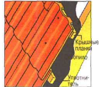
Черепичные плитки лежат выступающим профилем на решетинах. С боков они входят друг в друга, образуя защиту от дождя.
