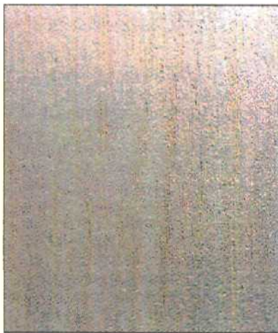
Поверхность, казавшаяся безупречно гладкой, после увлажнения стала грубой, ворсистой.
