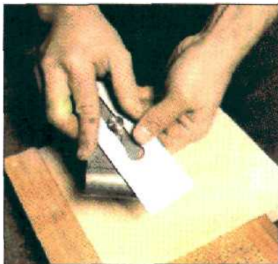
1. Нож и накладка соединены одним винтом. Ослабьте винт, поверните нож на 90 градусов и разъедините детали.
