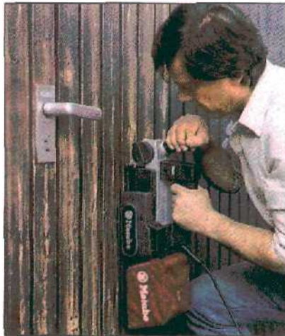
При работе "с рук" ведите ленточную машину по изделию вдоль волокон древесины; абразивная пыль тотчас отсасывается.
