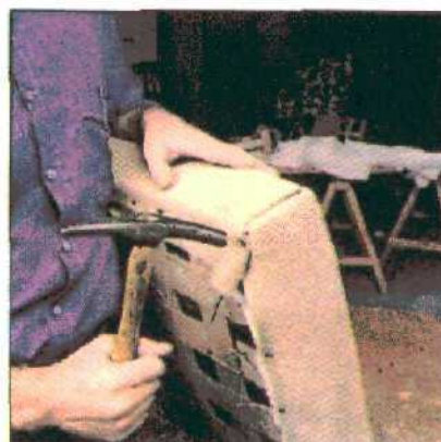
3. Используя тонкие ткани, можно обойтись без надрезов.
