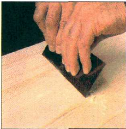
Циклей зачищают неровности, оставленные рубанком, или торчащие волокна древесины.
