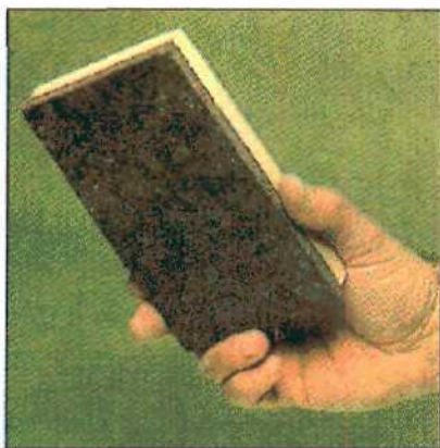
Самодельное приспособление для шлифования лакового покрытия: к деревянной пластине, которая служит рукояткой, приклеивают кусок толстого войлока.
