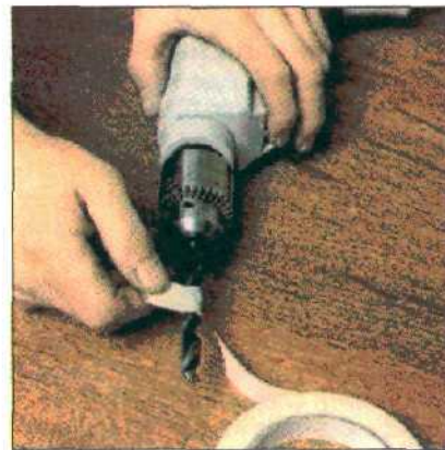
Манжета-ограничитель: лента, наклеенная на сверло на заданном расстоянии от вершины, обозначает глубину сверления.
