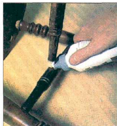
Оттяните детали как можно дальше и в гнездо под шип впрысните новый клей.
