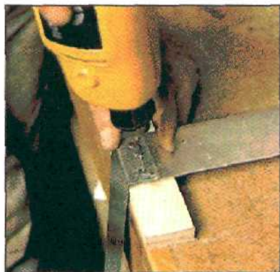
Неудачно поставленную заклепку можно высверлить и вместо нее поставить другую, большего диаметра.
