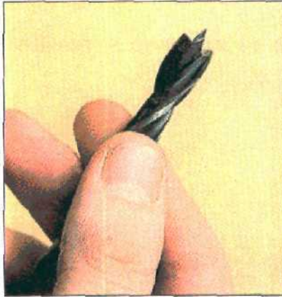
Типичное сверло для дерева с острием в центре (два подрезателя и фрезерирующая фаска выделяются светлым).
