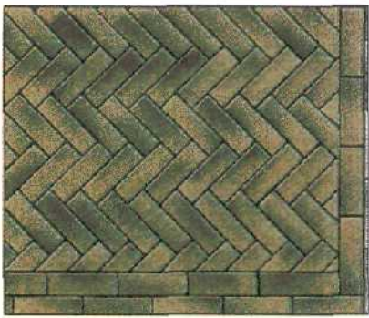
Настил "ёлочкой" с двойным фризом. При такой укладке используется только штучный паркет.
