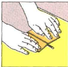
Надрезанную плитку положите на две спички и разломите равномерным нажимом.
