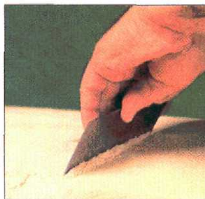
Цикля удаляет перемычки между следами рубанка и все неровности, которые еще остались на поверхности дерева.
