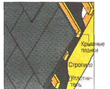
Шиферные плитки прибиваются гвоздями. Они заходят друг на друга внизу и одним боком, создавая уплотнение.
