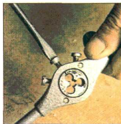
С помощью винтов регулируется положение лезвий: средний винт их раздвигает, два крайних - сжимают.
