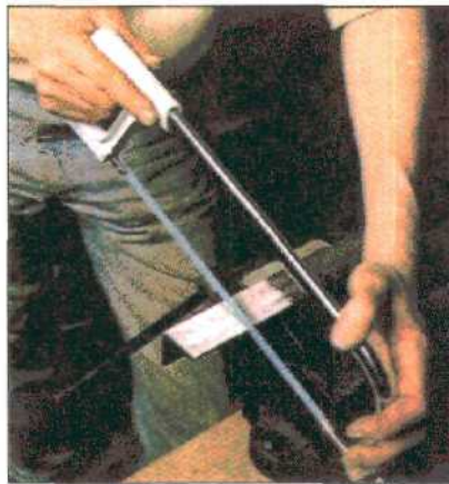
Направляйте ножовку обеими руками: правая удерживает рукоятку, левая находится на раме. Пилите равномерными толчками и с сильным нажимом.
