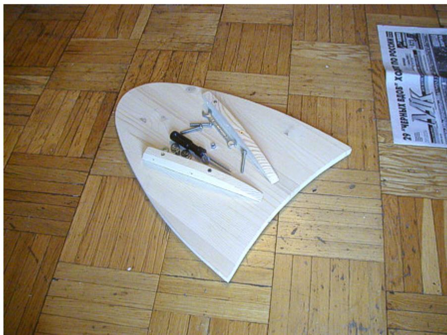
Рис. 12. Специальные элементы, к которым крепятся вертикальные детали столика
