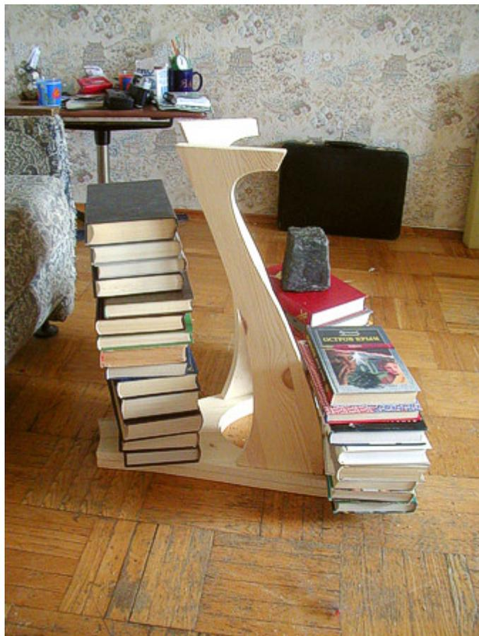
Рис. 11. Приклеивание второго слоя опоры под нагрузкой
