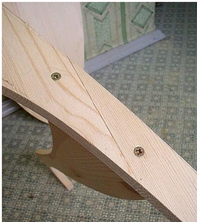
Рис. 10. Трещина в опоре
