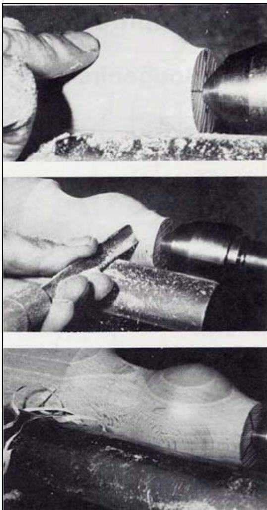
Fig. 14 (en haut, à droite). Forme obtenue au gros ciseau
