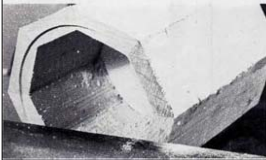
Fig. 5 (en haut, à gauche). Les planches coniques sont collées et assemblées par serrage à l'aide de colliers de serrage Jubilee ou Strip-Strap dont la tension est réglable au moyen d'un boulon.
