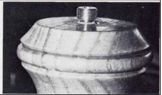
Fig. 14 (ci-dessus, à gauche). Table de tour réglée pour le perçage d'un socle de lampadaire pour le passage du fil.
