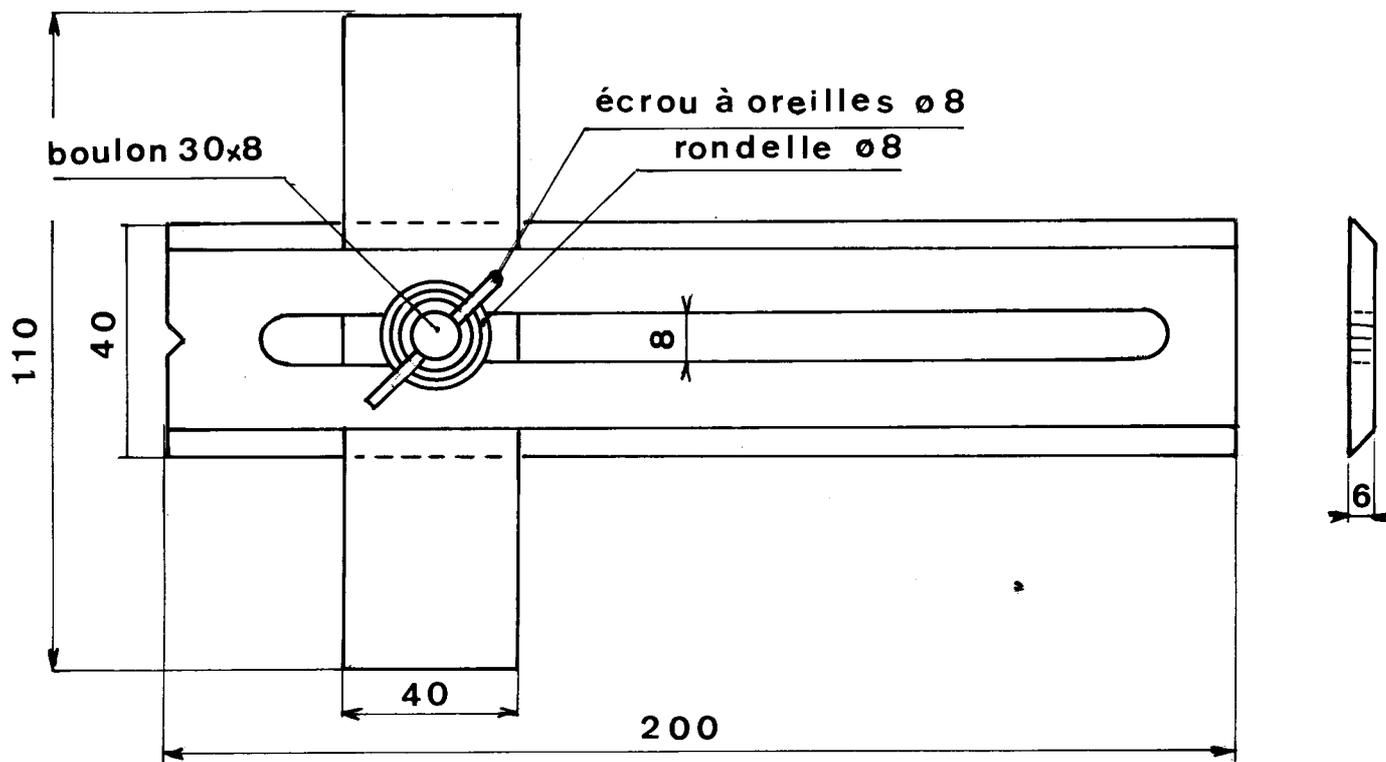
*Fabrication d'un trusquin à dessin.*
