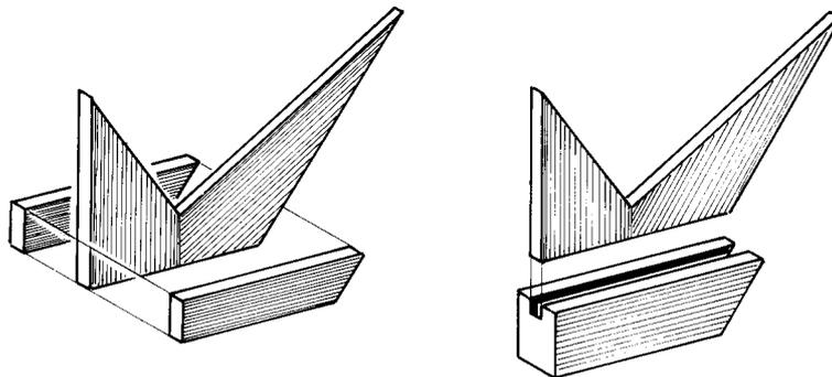
*Fabrication de l'équerre d'onglet de menuisier.*
