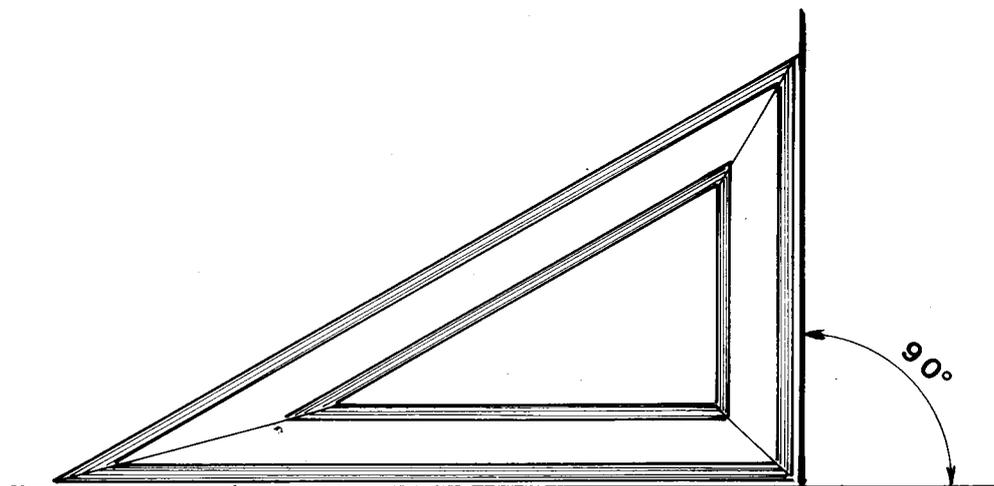
*Tracé d'une perpendiculaire à l'aide d'une équerre à dessin.*
