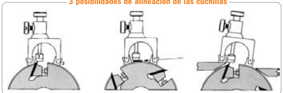
Colocación en el cuerpo del cabezal con marcado en las cuchillas originales.
