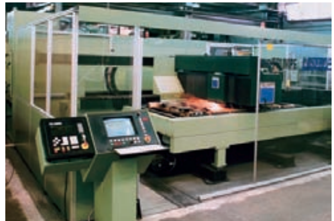
Corte al láser del cuerpo de las sierras.
