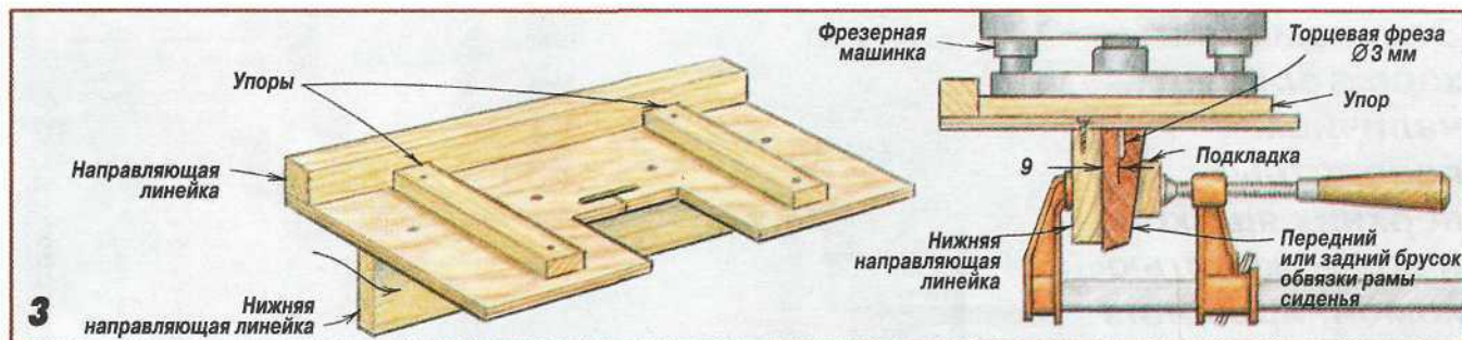
Рис. 3. Приспособление для выборки пазов под металлические пластины.
