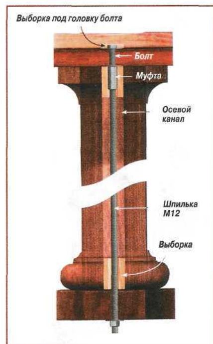
Рис. 7. Сборка столика. Дополнительную опору столешницы, ножку и основание прочно свинчивают с помощью болта М12, муфты и резьбовой шпильки.
