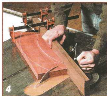
Концы заготовок сегментов зашлифовывают под углом 60°.
