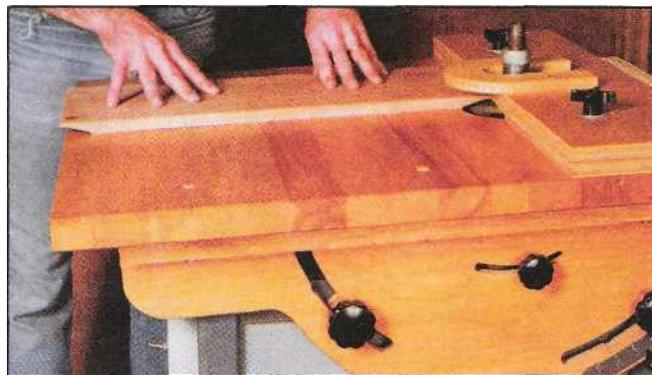
При подаче панели к фрезе U-образная защита на регулируемом ограждении предохраняет руки от травм,
