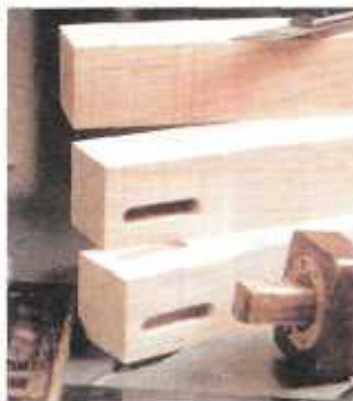
Гнезда под шипы размечают на первой ножке (сверху). После выборки гнезда и подгонки можно выбрать пазы на остальных ножках, ориентируясь только на разметку оси (внизу).
